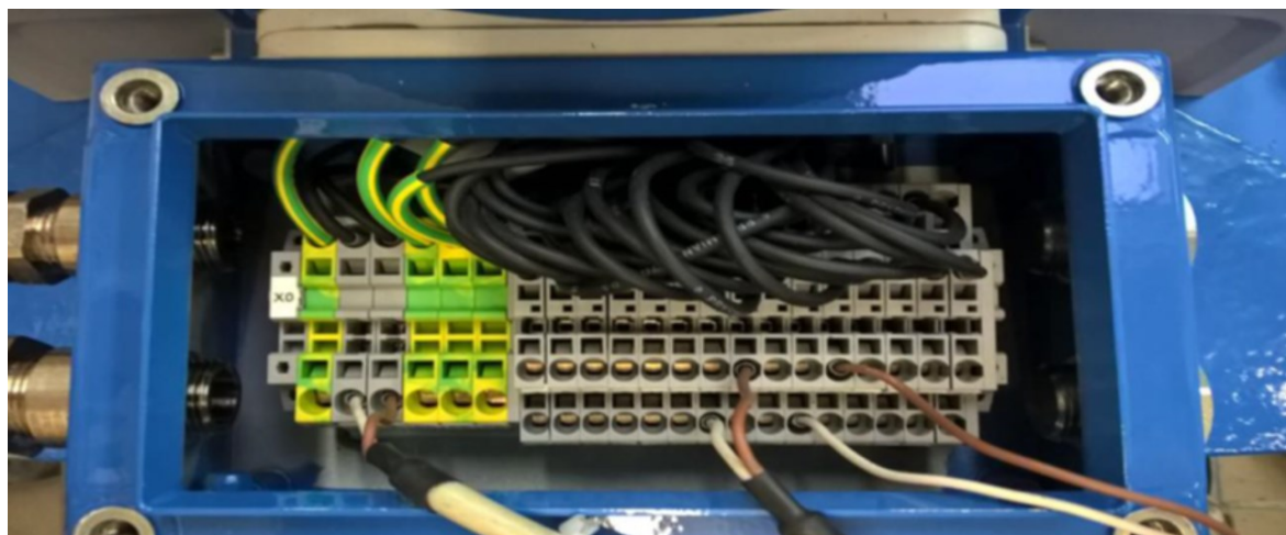
Fig. 8.21: Collegamento dell'RS 485-2 (22 +, 23 -) all'USM GT400
