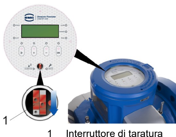
Fig. 10.7: Chiusura dell'interruttore di taratura
