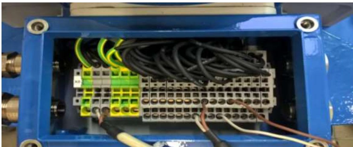
Fig. 8.19: Collegamento dell'RS 485-2 (22 +, 23 -) all'USM GT400
