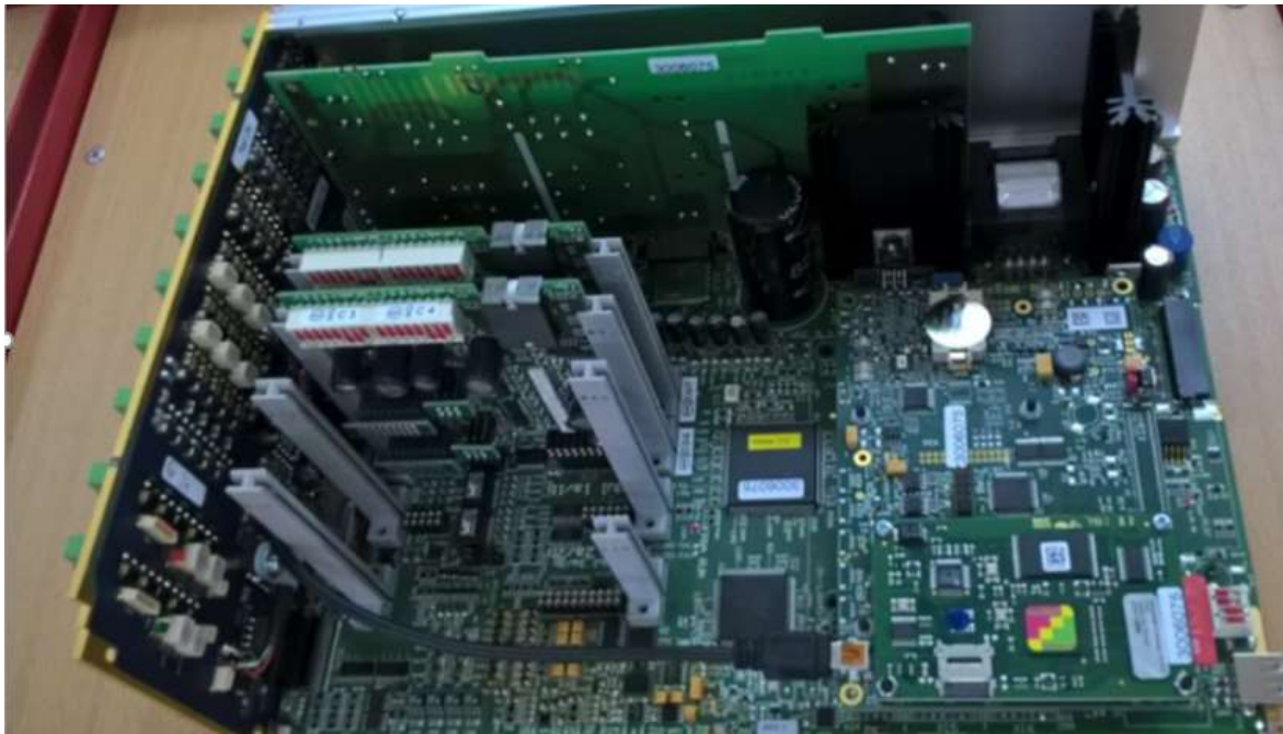
Fig. 8.21: Slot per COM6 e 7 dell'ERZ 2000-NG
