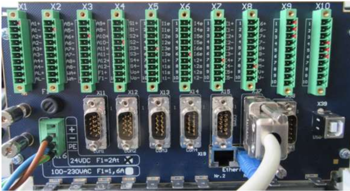
Fig. 8.18: Collegamento dell'interfaccia Modbus dell'USM a COM 6
