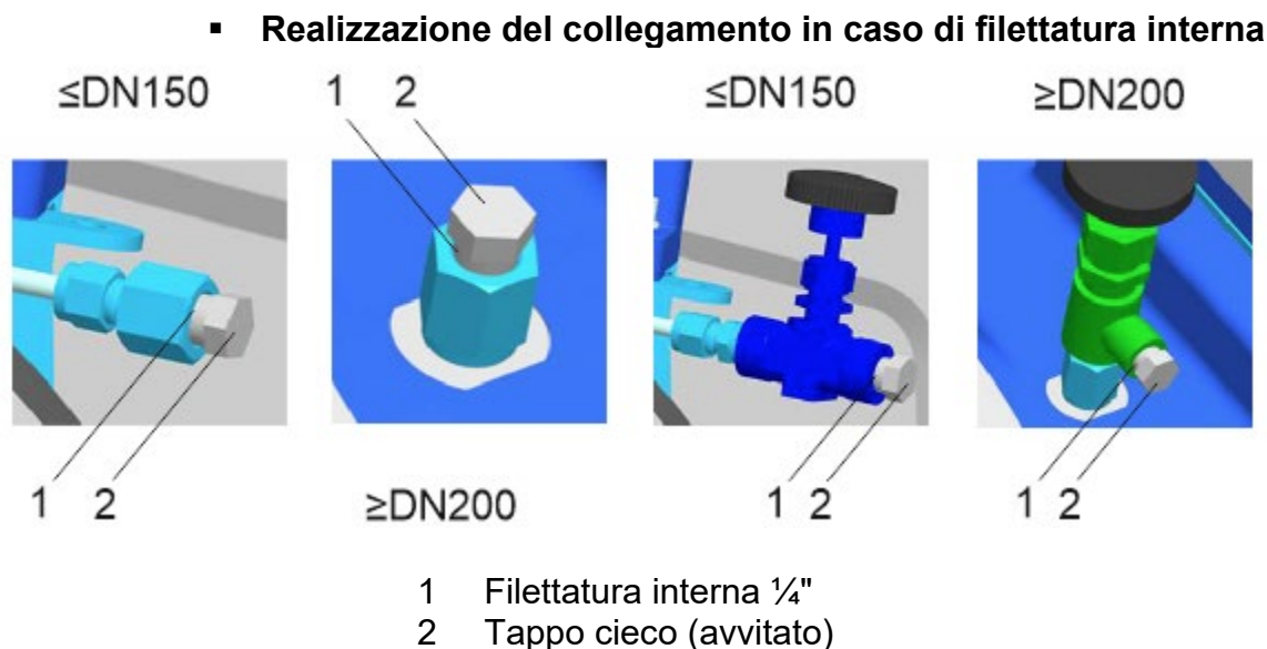
Fig. 8.44: Possibilità di connessione del collegamento in pressione con filettatura interna
