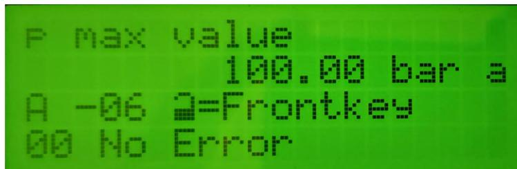
*Imagen 3.3: Pantalla del sistema electrónico del medidor por ultrasonidos*
