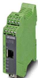
Abb. 8.27: Schnittstellenwandler Ethernet auf RS485
