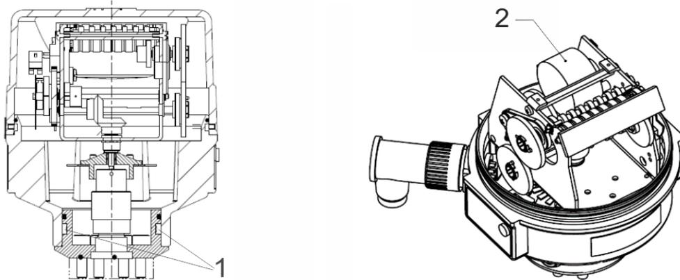
**Abbildung 3: Zählwerkskopf Typ „F“**
