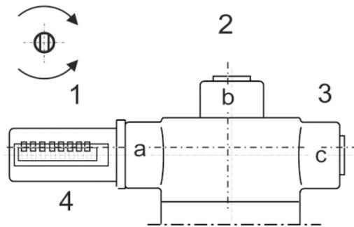
**Abbildung 7: Drehrichtung der Abtriebswellen**
