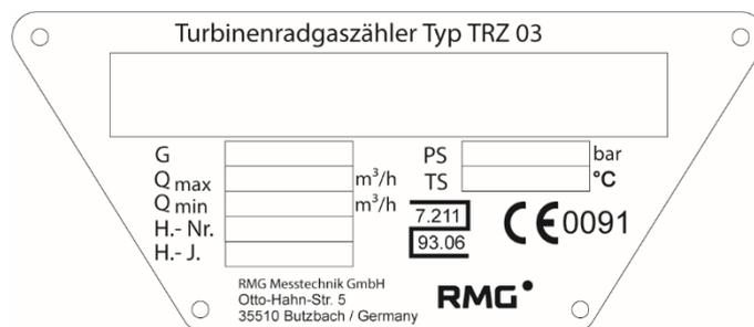
Hauptschild Turbinenradgaszähler TRZ 03 mit Zählwerkskopf Typ „F“ (PTB-Zulassung)
