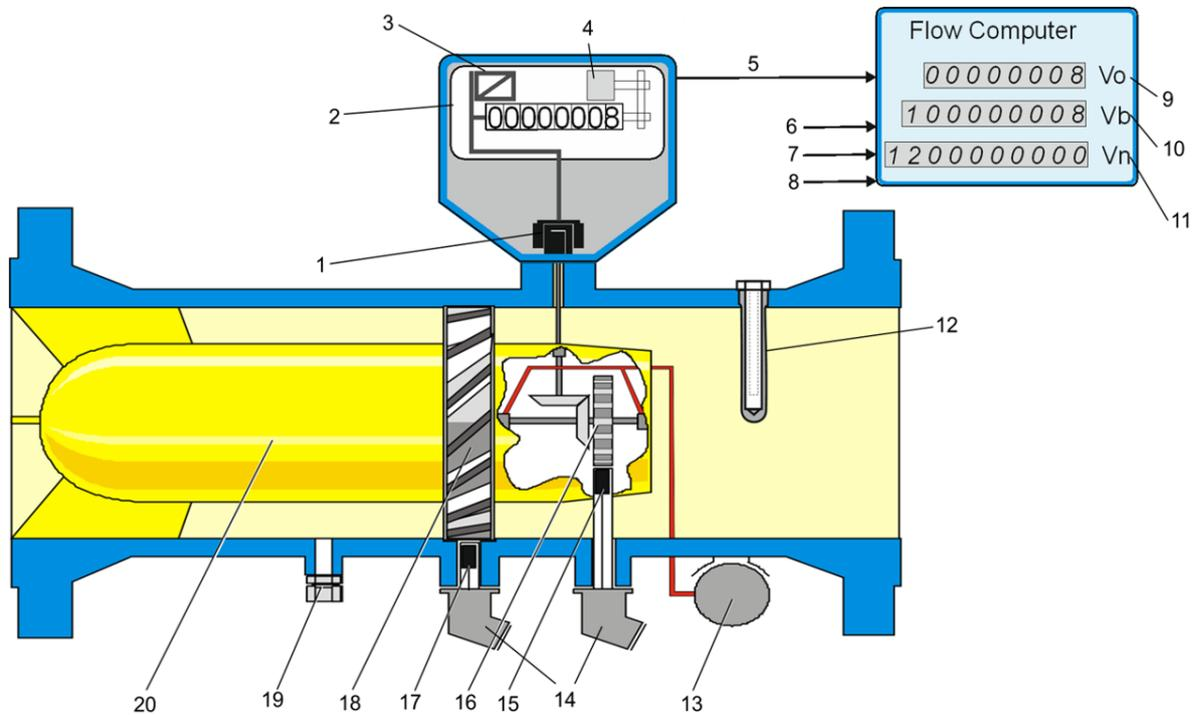
**Abbildung 1: Schnitzzeichnung Turbinenradgaszähler**
