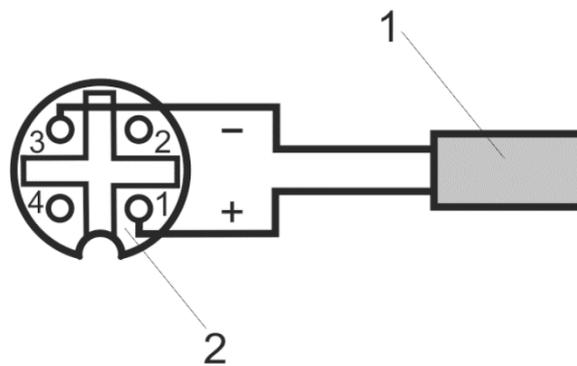
**Abbildung 11: Steckerbelegung für den HF 2/3 Impulsgeber**
