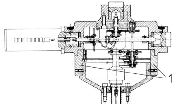
Abbildung 6: Zählwerkskopf Typ „D“
