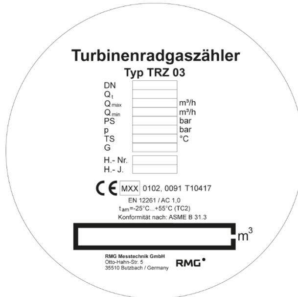
Hauptschild Turbinenradgaszähler TRZ 03 mit Zählwerkskopf Typ „A“
