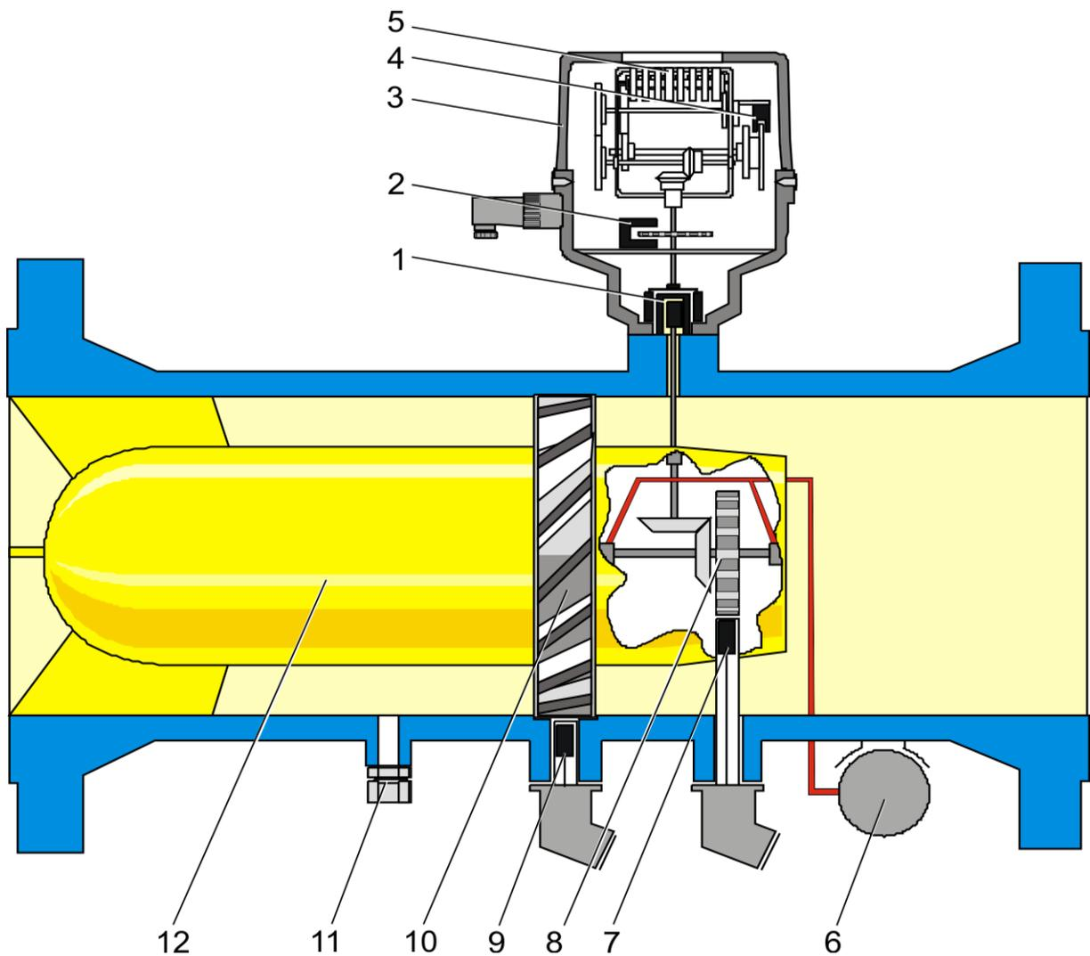
**Abbildung 12: Schnittzeichnung Turbinenradgaszähler**
