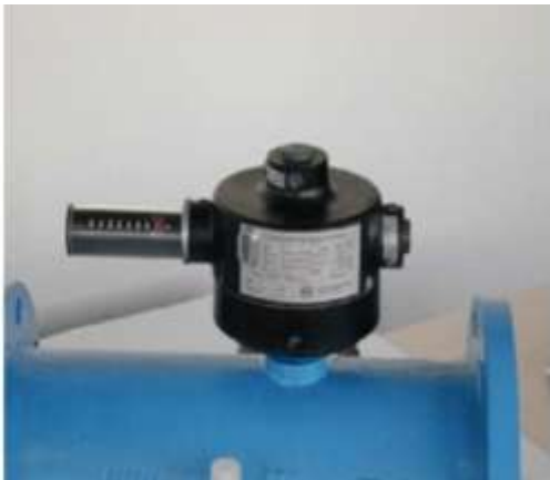
Figura 6: Testina di misura tipo „D“
