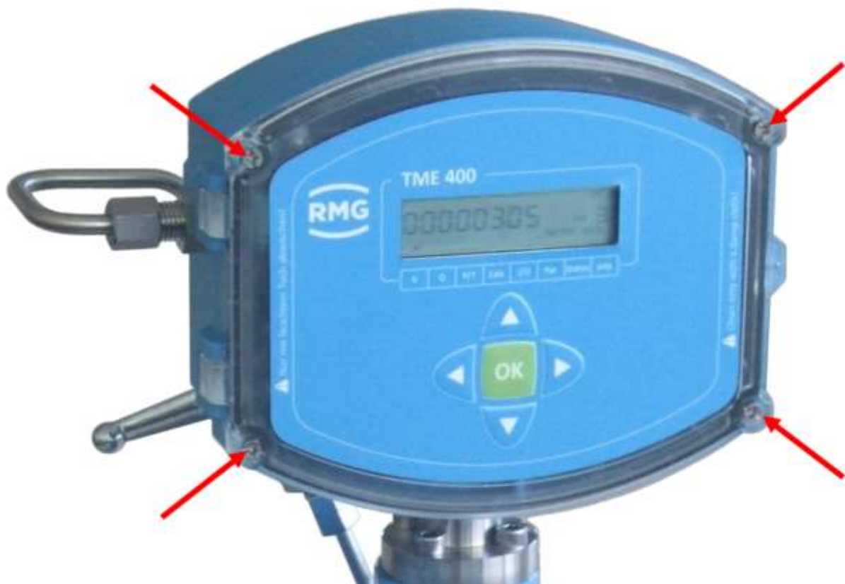
Abbildung 3: Lösen der Schrauben zum Öffnen des Deckels
