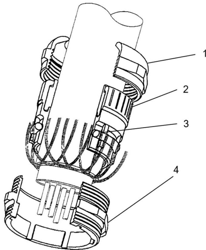
**Abbildung 16: Klemmverschraubung**
