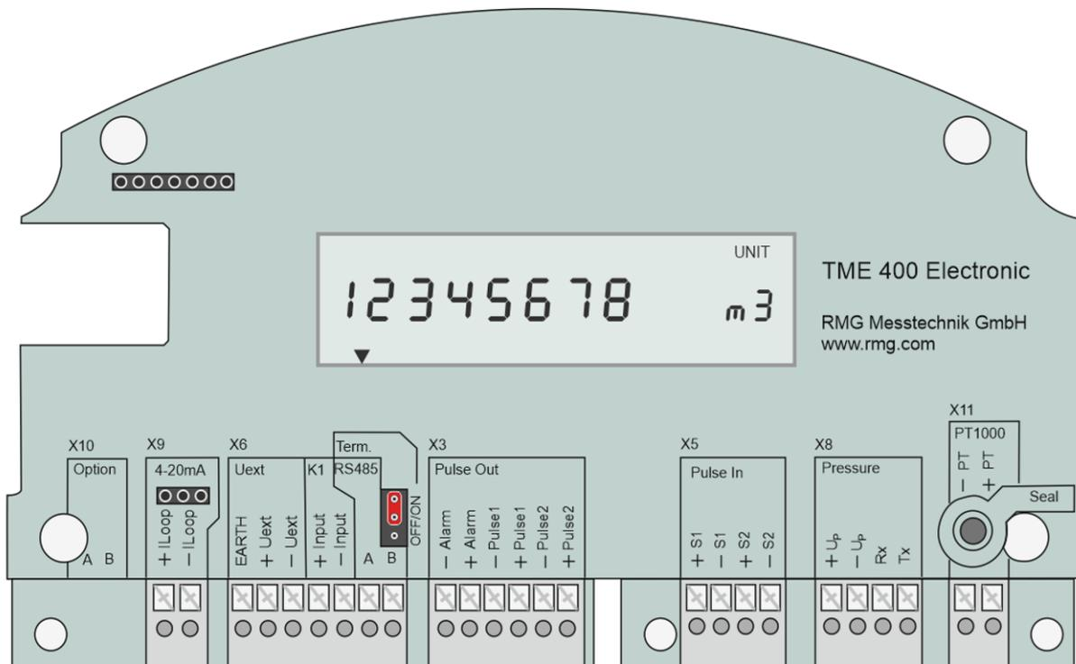
**Abbildung 6: Anschlussbelegung des TME 400**
