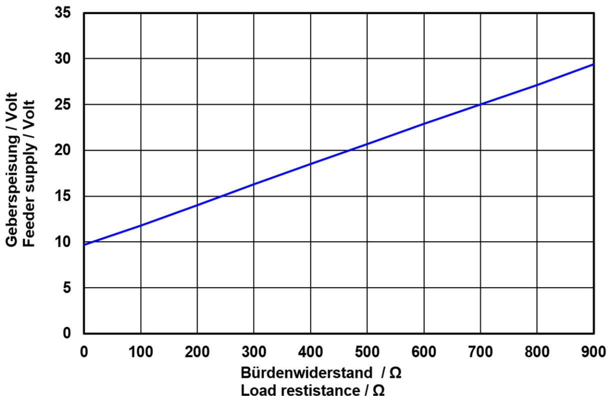
**Abbildung 15: Bürde in Abhängigkeit der Geberspeisung**
