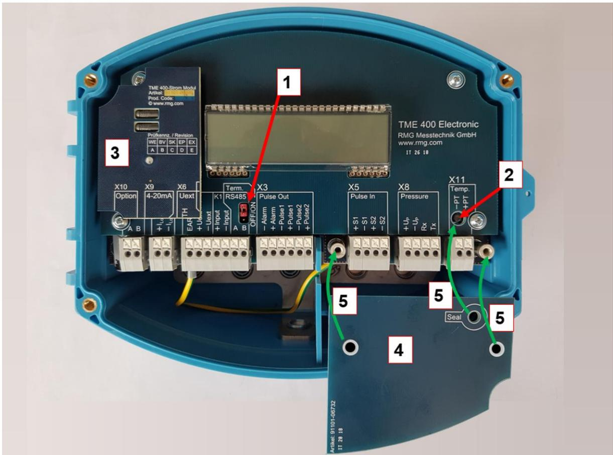
**Abbildung 5: Elektronik mit Abdeckung des Eich-Tasters**
