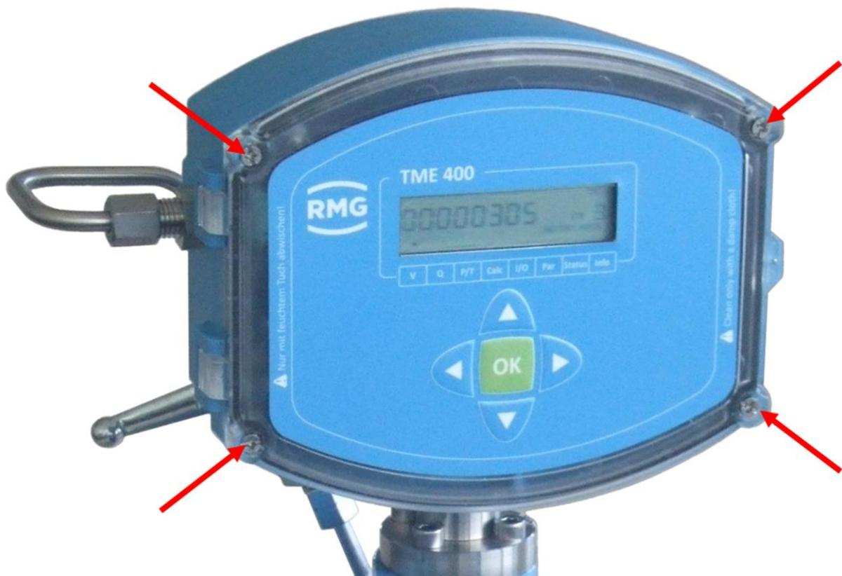
**Abbildung 4: Lösen der Schrauben zum Öffnen des Deckels**
