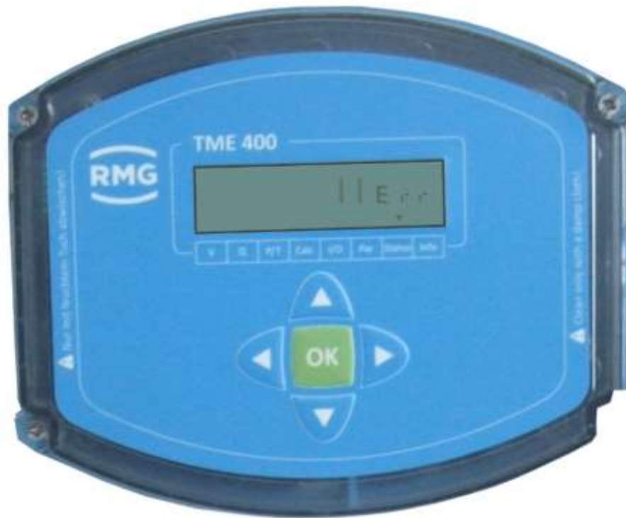
Abbildung 18: Fehlermeldung im Display
