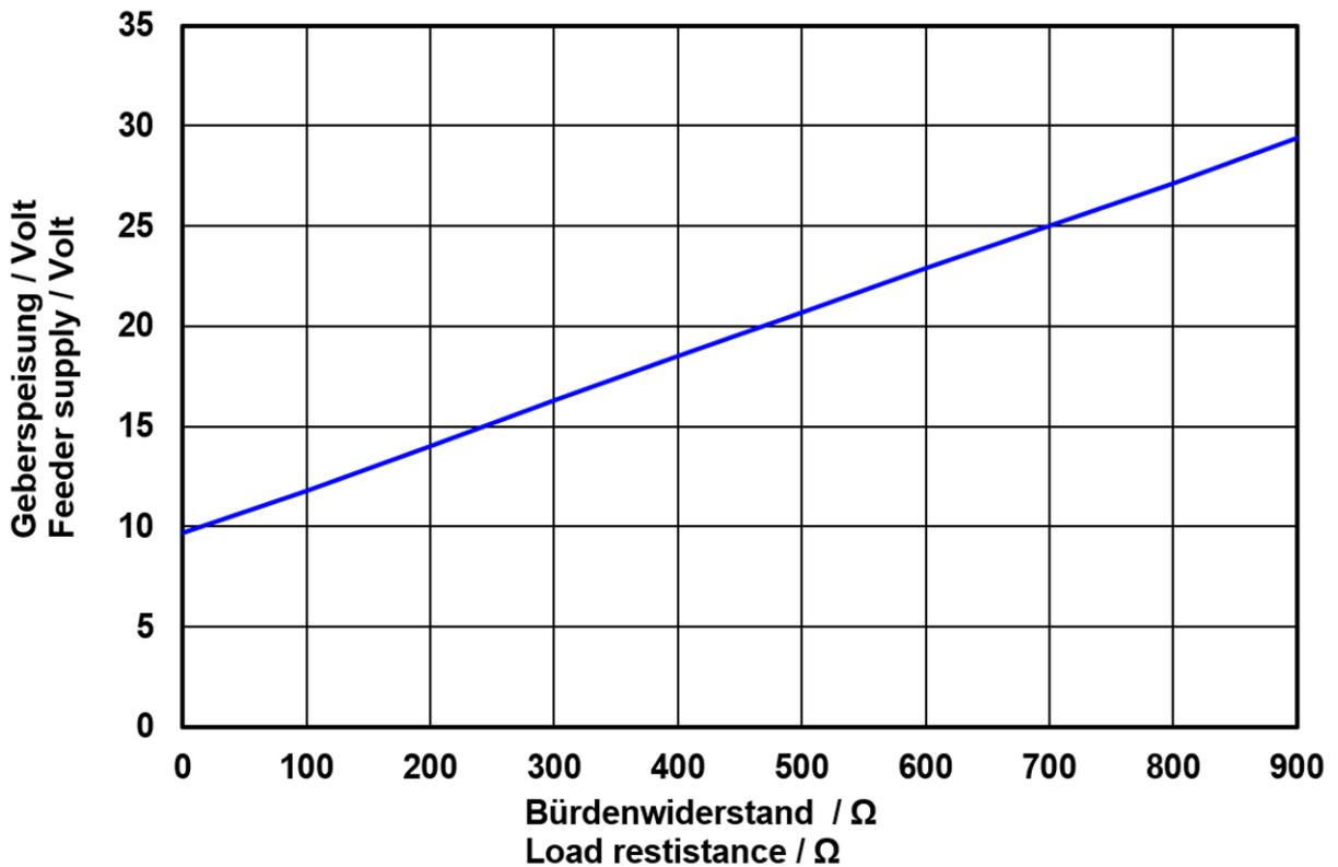
**Abbildung 15: Bürde in Abhängigkeit der Geberspeisung**
