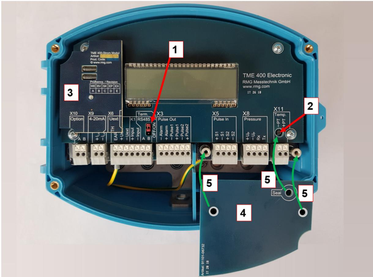
**Abbildung 5: Öffnen der Schrauben zum Entfernen der Abdeckung**
