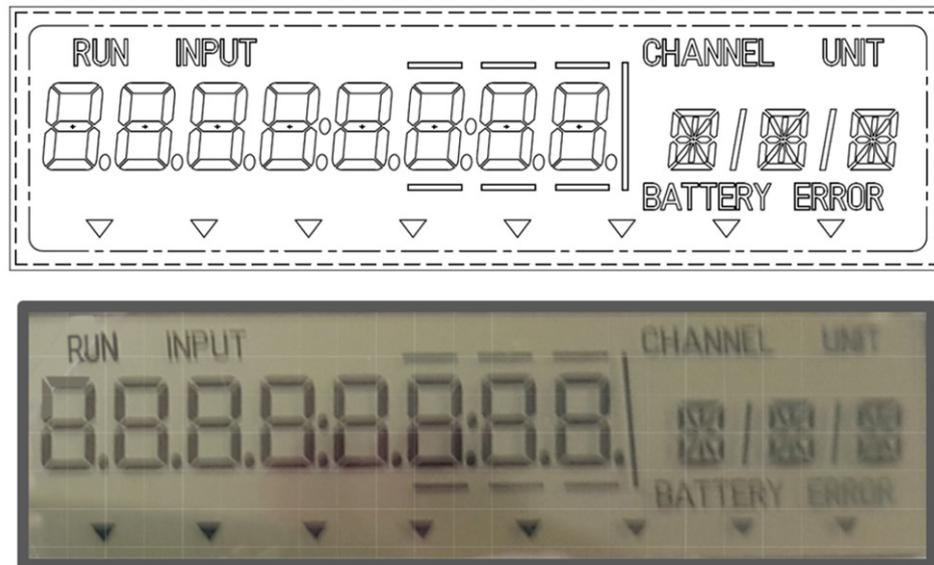
**Abbildung 8: Anzeige beim Displaytest**
