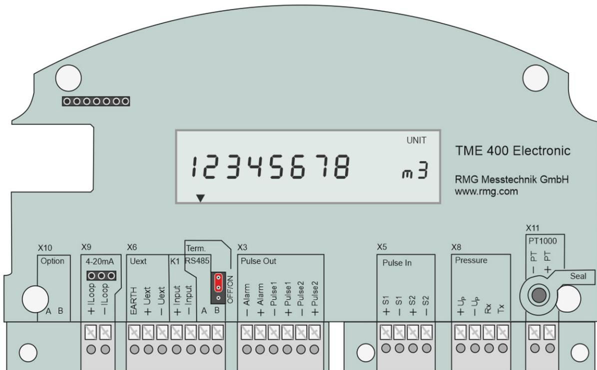
**Abbildung 6: Anschlussbelegung des TME 400**
