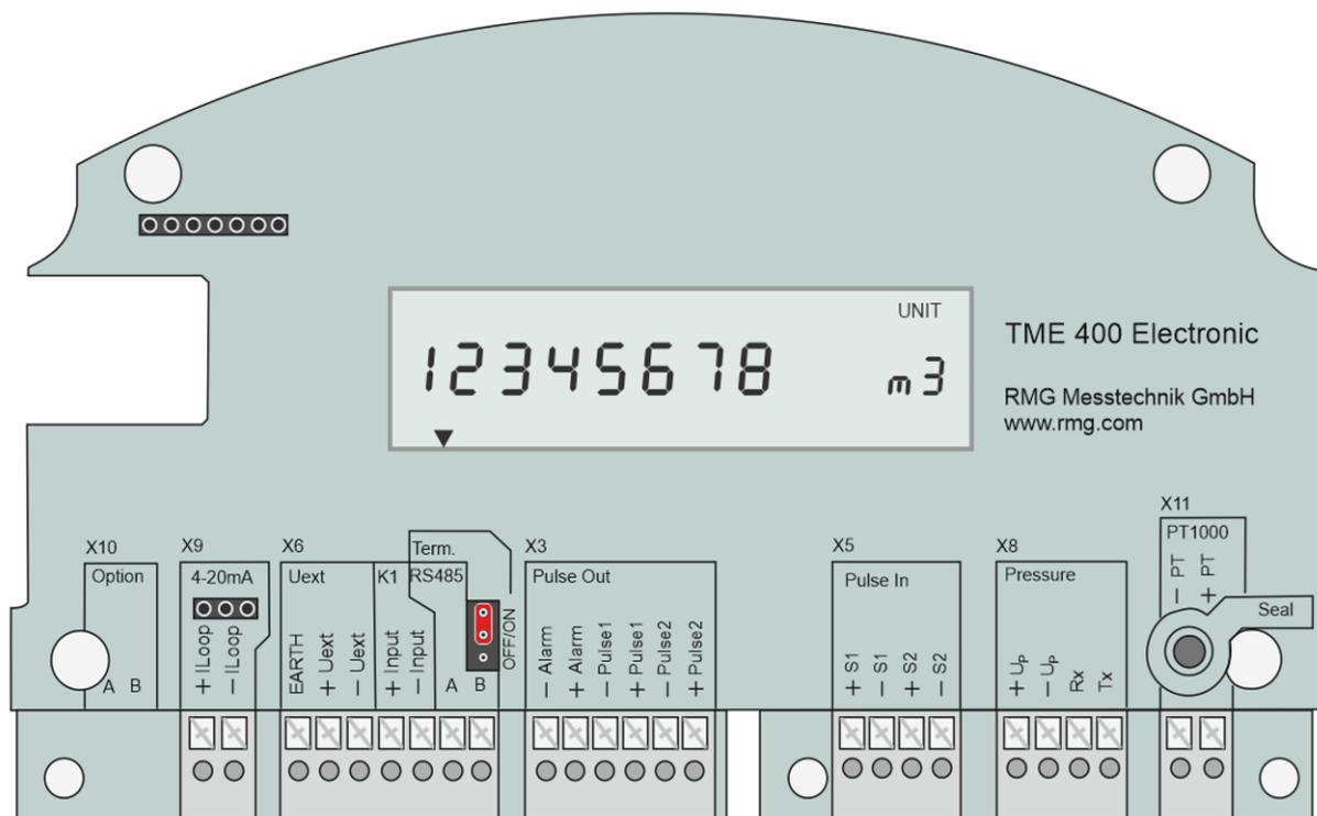
**Abbildung 6: Anschlussbelegung des TME 400**
