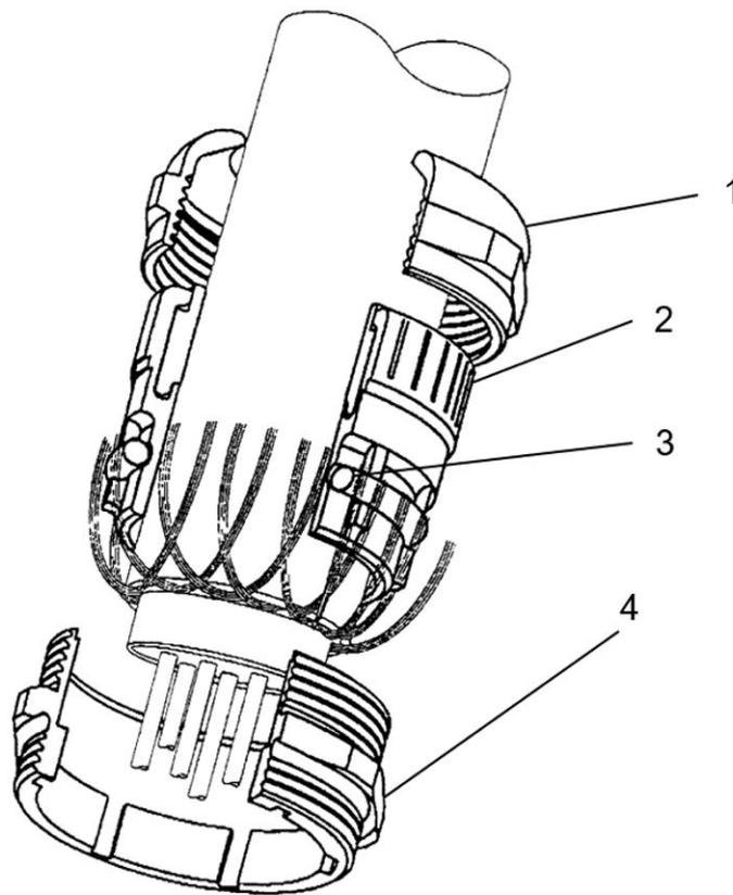
**Abbildung 16: Klemmverschraubung**
