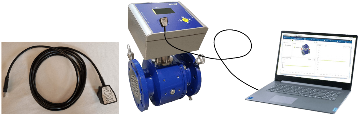
Abbildung 52: Datenverbindung mit der RMGView RSM
