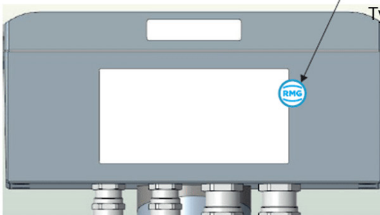
Abbildung 65: Plomben auf dem Elektronikgehäuse des RSM 200
