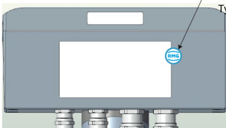
Figura 64: Sigilli sull'alloggiamento dell'elettronica dell'RSM 200
