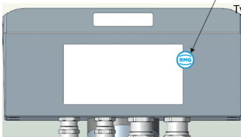
Abbildung 64: Plomben auf dem Elektronikgehäuse des RSM 200
