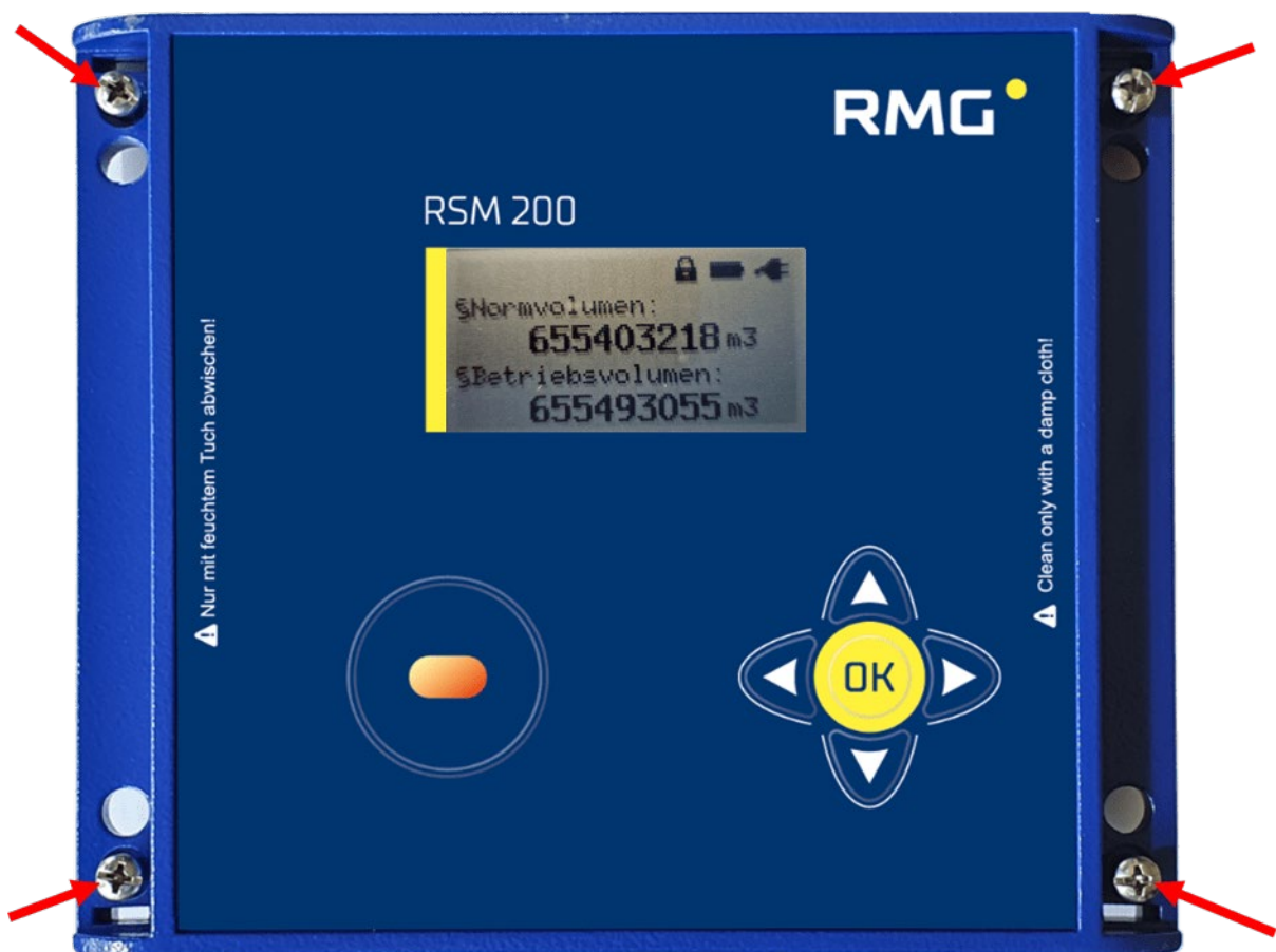
Abbildung 8: Lösen der Schrauben zum Öffnen des Deckels
