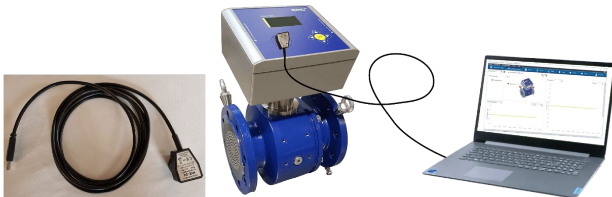
Abbildung 51: Datenverbindung mit der RMGView RSM
