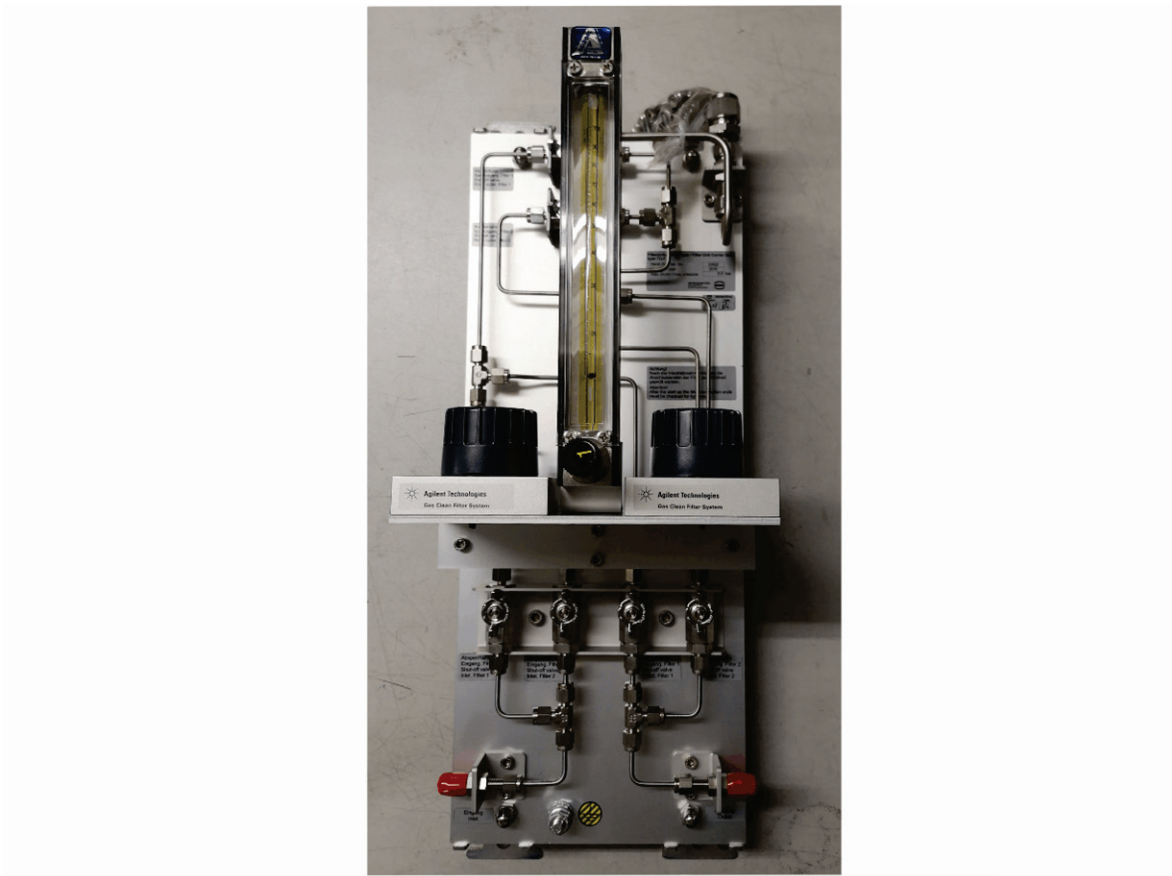
Abbildung 29: Vorfilter Spüleinheit ohne Filterbestückung
