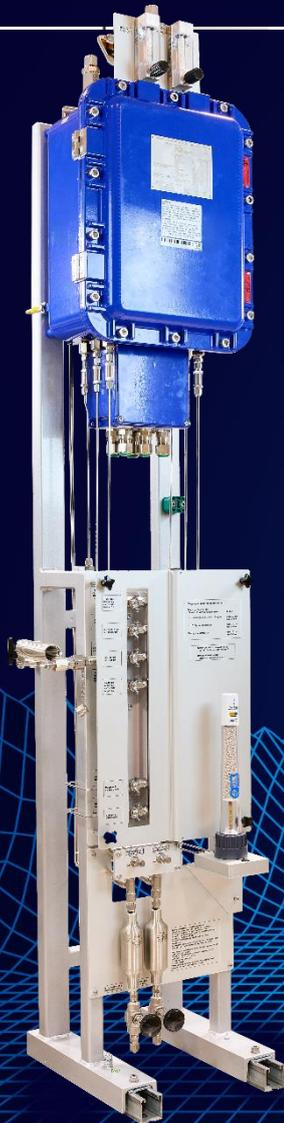
Der Prozess-Gaschromatograph RGC 7 analysiert die Zusammensetzung von Erdgas mit Beimischung von Wasserstoff und bestimmt dessen wichtigste Komponenten.
