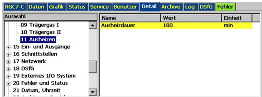
Abb. 35: Menü Detail – Ebene 14.11 Ausheizen (Ansicht bei gewähltem Benutzerprofil "Anwender")
