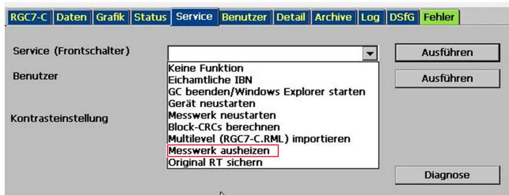
Abb. 37: Menü Service – Einstellung Messwerk ausheizen
