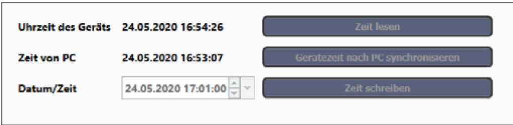
Abb. 68: Zeitverstellung über die Stundengrenze
