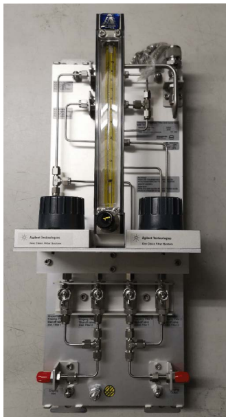
Abb. 19: Vorfilter-Spüleinheit ohne Filterbestückung
