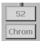
Graue Farbe des Gasstrom-Symbols und graue Schrift bedeuten, dass der Gasstrom für die vorliegende Geräteausführung nicht verfügbar ist.
