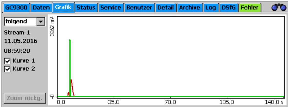
Im Bildschirm „Grafik – Chrms“ werden die Chromatogramme, d. h. die Signalkurven, der letzten Analyse angezeigt. Wie unter „Daten“ beschrieben, wird mit dem Auswahlfeld links oben der Gasstrom bzw. die Gasart gewählt. Zusätzlich gibt es hier den Auswahlpunkt „verworfen“, für SKIP – Analysen, die dem Spülen dienen und deren Ergebnisse keinem Gasstrom zugeordnet wurden.
