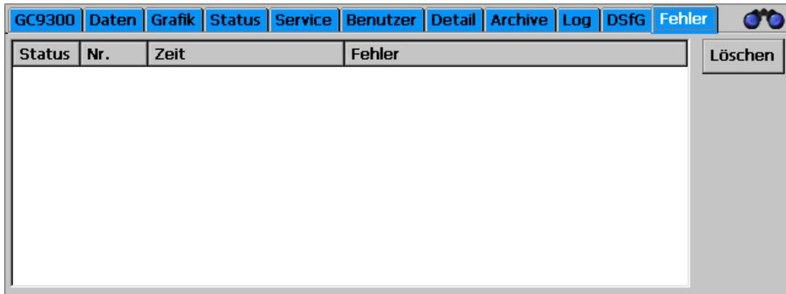
Alle zuletzt aufgetretenen und noch nicht quittierten Fehler werden angezeigt. Fehlermeldungen, die nicht mehr anliegen (grün), können hier gelöscht werden. Fehler mit rotem Hintergrund sind Alarme (A), d.h. die eichamtliche Messung ist gestört, Fehler mit gelbem Hintergrund sind Warnungen (W), d.h. die eichamtliche Messung ist nicht beeinträchtigt, Hinweise (H) mit lilafarbenem Hintergrund sind Informationen, die nicht im Zusammenhang mit Fehlern stehen.
