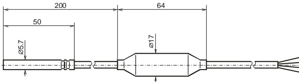
Abb. 42: Sensorabmessungen
