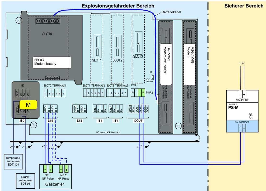
Abb. 20: Externe Spannungsversorgung PS-M für das interne Modem mit der Versorgung PS-M
