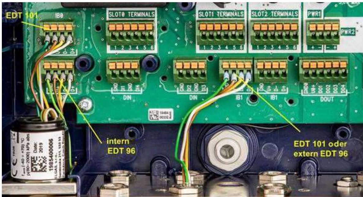
Abb. 18: Anschluss der Sensoren EDT 96 und EDT 101
