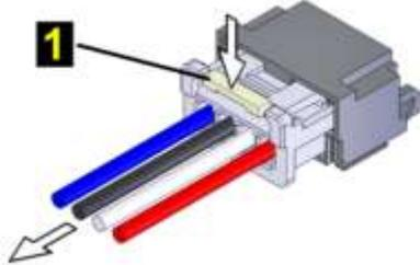
Zum Trennen des Steckverbinders zunächst auf die Sperre drücken, um den Steckverbinder zu entriegeln und ihn dann vorsichtig aus der Buchse zu ziehen. Beim Festhalten und Ziehen des Kabels keinesfalls Kraft anwenden. Andernfalls kann es beschädigt werden.
