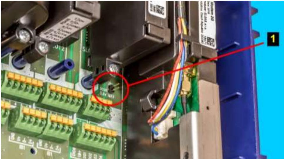
Abb. 40: Installation der Brücke JP1 auf der E/A-Karte
