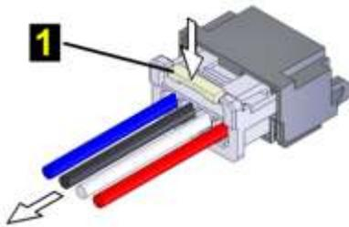
Um das Kabel wieder mit dem Gerät zu verbinden, den Steckverbinder vorsichtig einstecken, sodass die Sperre einrastet. Dann leicht am Kabel ziehen, um es auf festen Sitz zu überprüfen.
