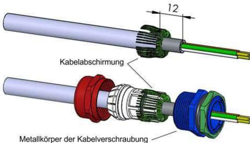
Abb. 10: Verbindung der Kabelabschirmungen in den Kabelverschraubungen
