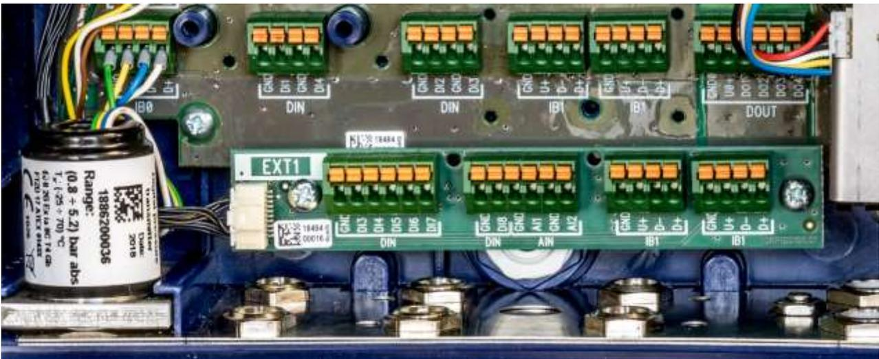
Abb. 44: Zusatzanschlusskarte EXT1-T für das Modul S0-EXT1
