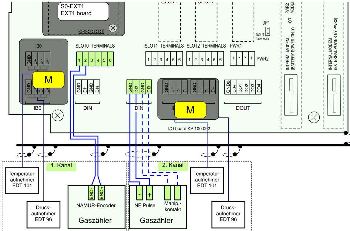
Abb. 14: Anschließen des Gaszählers mit NAMUR-Encoder am Prilog 400
