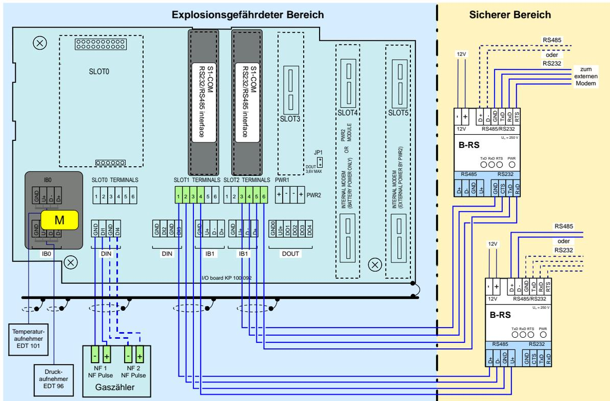
Abb. 22: Prilog 400, Kommunikation über zwei unabhängige Schnittstellen RS232/RS485
