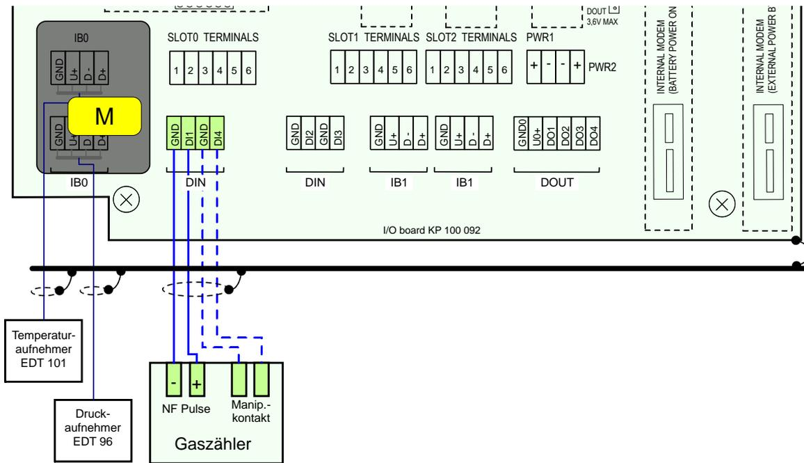
Abb. 12: Anschließen des NF-Gaszählers am Prilog 400 (Einkanal)
