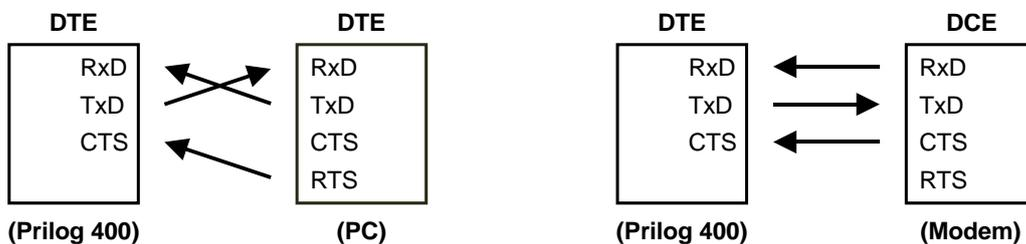
Der Prilog 400 wird über ein externes Modul B-RS, B-RS/A angeschlossen. Dieses Kommunikationsmodul beinhaltet eine interne Signalkreuzung. Daher werden ein PC und ein Modem wie folgt angeschlossen:
