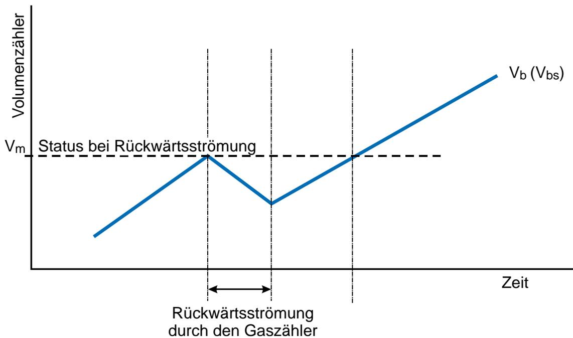
Abb. 43: Verarbeitung der Volumina bei umgekehrter Gaszählerdrehung
