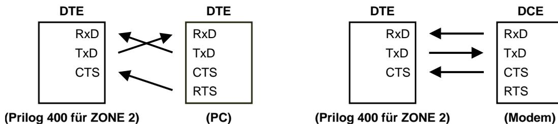
Im Fall des Prilog 400 für Zone 2 muss keine B-RS-Sicherheitsbarriere (B-RS/A) verwendet werden, die eine Signalkreuzung umfasst. Aus diesem Grund muss die korrekte Verdrahtung der verwendeten Kabel überprüft werden:
