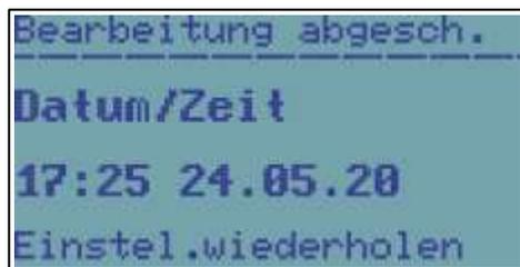
Abb. 49: Zeitverstellung, Fehlermeldung am Gerätedisplay
