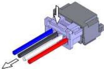
Kabel keinesfalls mit Kraftaufwand herausziehen. Andernfalls können sie beschädigt werden. Beim erneuten Einsetzen die Kabel so einführen, dass die Sperre sichtbar ist. Dann leicht am Kabel ziehen.
