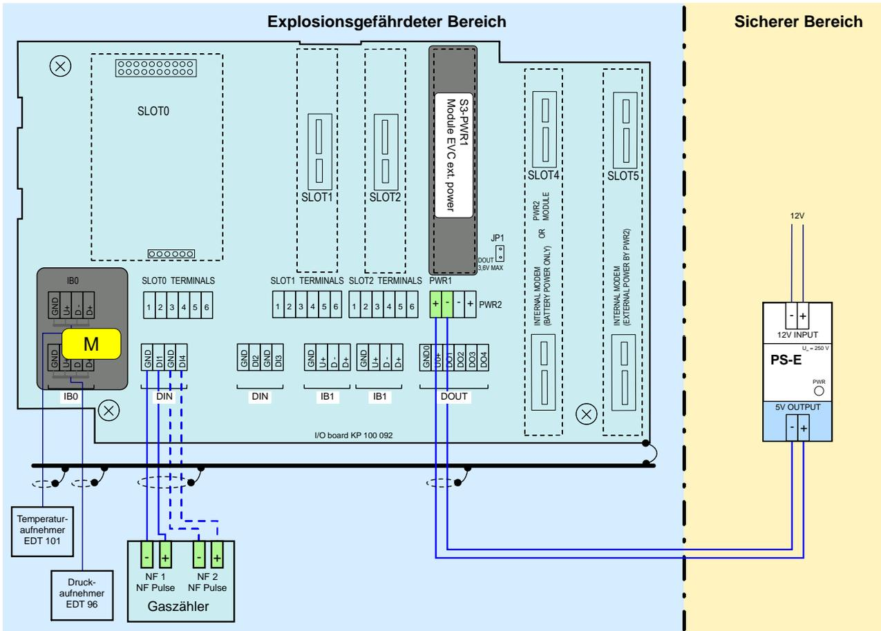
Abb. 19: Anschließen der externen Spannungsversorgung des Messwertregistrarerätes
