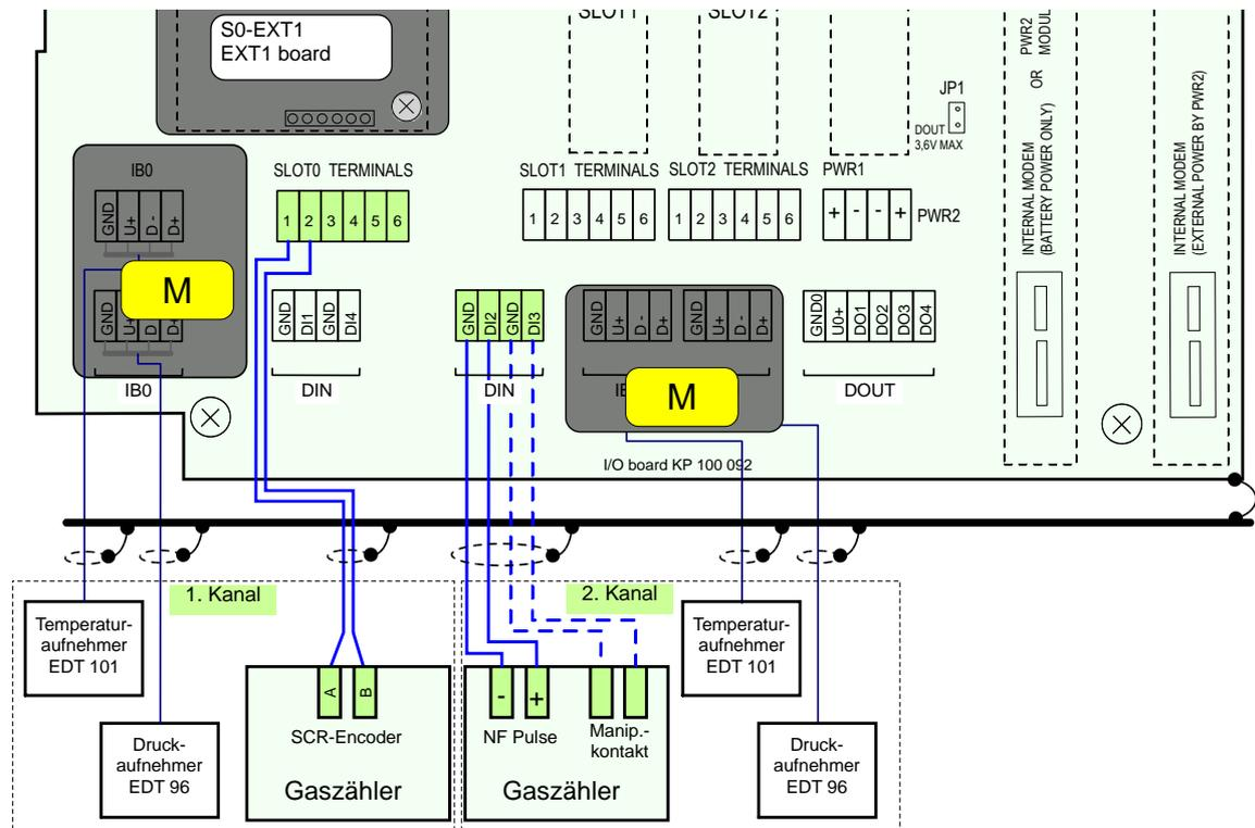
Abb. 15: Anschließen des Gaszählers mit SCR-Encoder am Prilog 400
